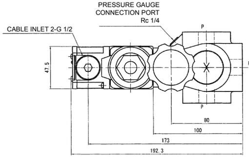
CLEARANCE REQUIRED TO REMOVE SOLENOID 242.5
