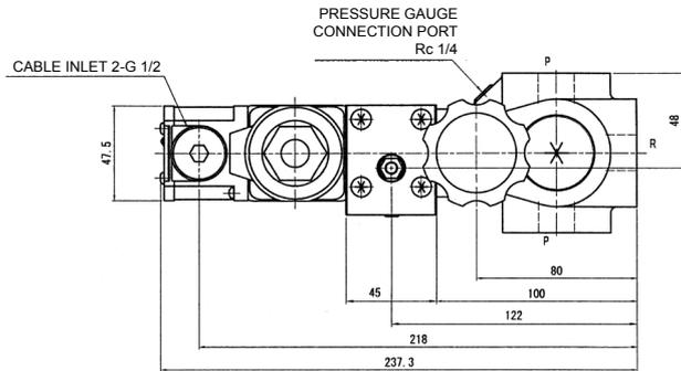
CLEARANCE REQUIRED TO REMOVE SOLENOID 242.5
