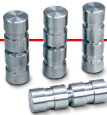
Die **ELCO-Kupplung** Bauform B ist die Abwandlung der normalen ELCO-Kupplung in eine Sicherheitskupplung und dient zum Schutz der drehelastisch verbundenen Maschinen vor unzulässig hohen Belastungen. Bei eintretender Überlastung werden die beiden Wellen durch Abscheren der Bruchbolzen voneinander getrennt.
