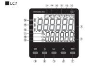
① PV 표시부: 계수값, 계시값, 배치계수값, 설정항목 표시 ② SV 표시부 : 카운터/타이머/배치설정값 표시
