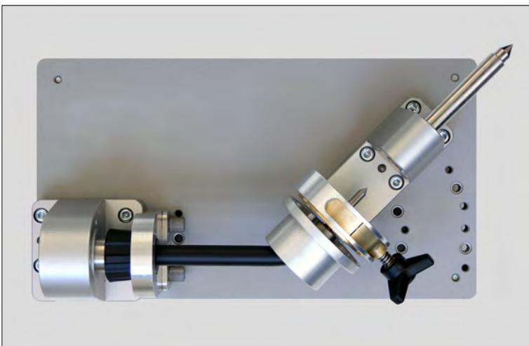
Prüfvorrichtung mit Pistolenkopf und Justiermodul (Anwendungsbeispiel)
