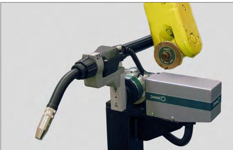
Pistolensystem in der Ablagestation vom Roboter abgekuppelt
