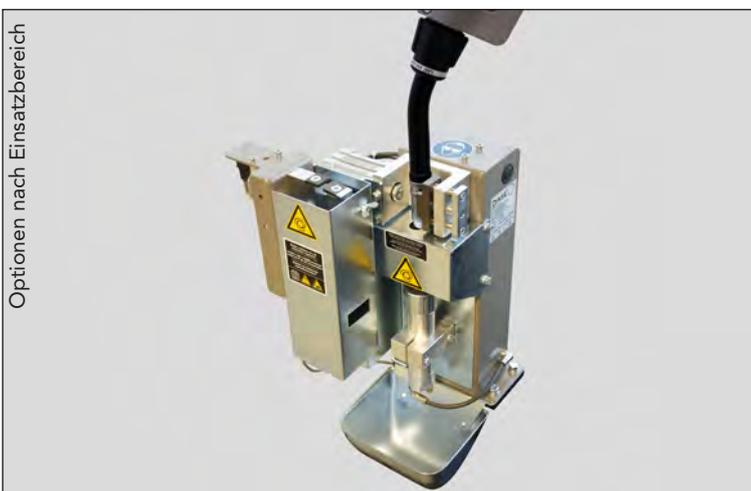
Roboter mit montiertem Dinse - Pistolenkopf während des Reinigungsvorgangs in der Pistolenreinigungs - Station
