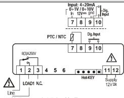
**Probe:** Pt100= 7 - 9 (8); Thermocouple J, K, S = 7(+); 9(-)
