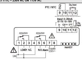
Probe: Pt100=9-11 (10); Thermocouple J, K, S= 9(+) - 11(-) 115Vac supply: 7-8
