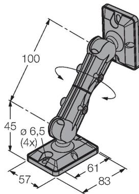
Befestigungsarm für UHF RFID Schreib-Lese Köpfe TNxxx-Q175L200-H1147, TNxxx-Q240L280-H1147 und TNxxx-Q280L640-H1147
