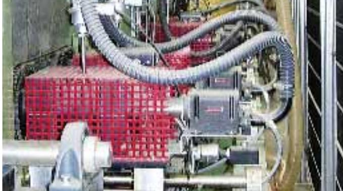
LHS-Lufterhitzer in einer Produktionslinie für Wärmedämmung.
