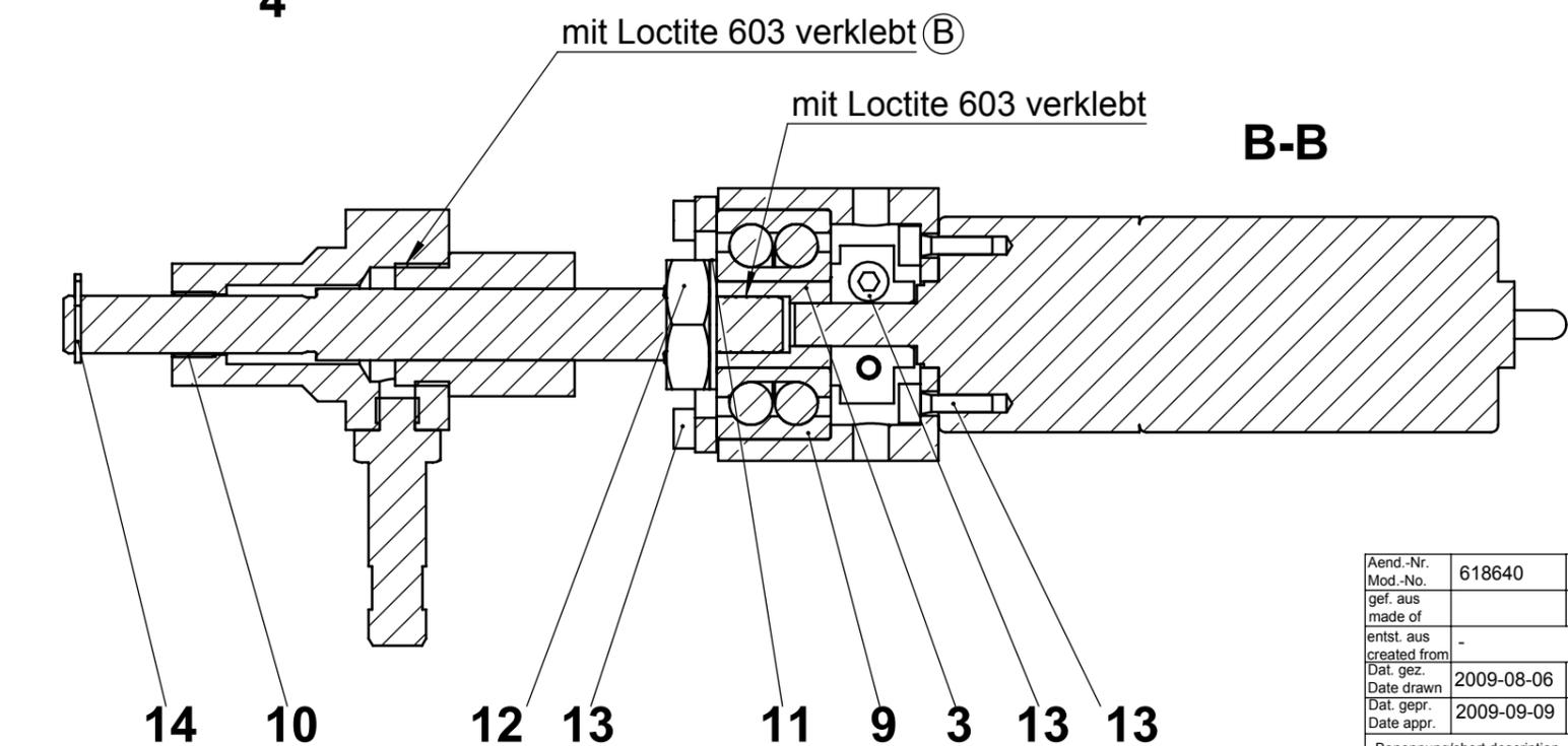
(B) Schrauben Pos.13 an der Klemmwelle Pos. 3 in drei Schritten abwechselnd gleichmäßig auf 1,3 Nm anziehen!
