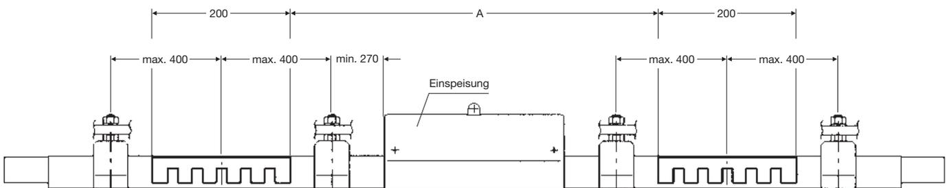
Als Sicherung gegen Spannungsüberbrückung und zum Freischalten von Reparatur-, Steuer- und Speiseteilstrecken werden zwei isolierte Trennstellen verwendet.
