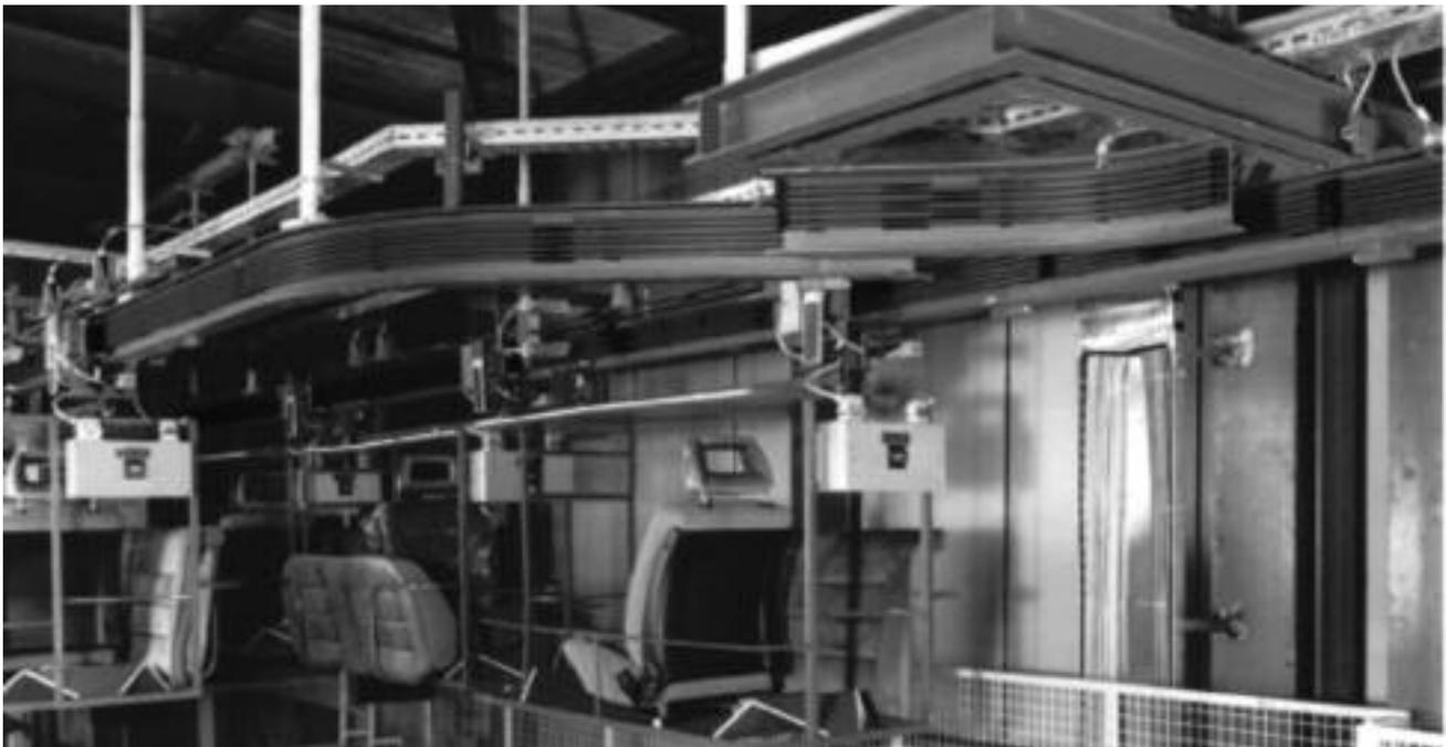
Isolierte Stromschiene U 15, 6-polig an einer Elektro-Hängebahn mit Schiebeweichen in einer Automobilfabrik.
