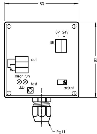
Darstellung Kontaktfunktion bei störungsfreiem Betrieb
