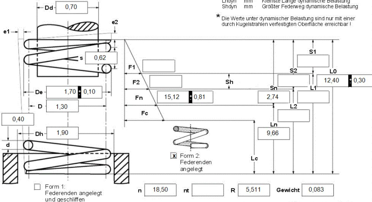
Federprüfung nach DIN ISO 2859/1 Prüfniveau II
