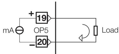
**2.3.5-F DOUBLE ACTION SSR DRIVE /RELAY (TRIAC) CONTROL OUTPUT**
