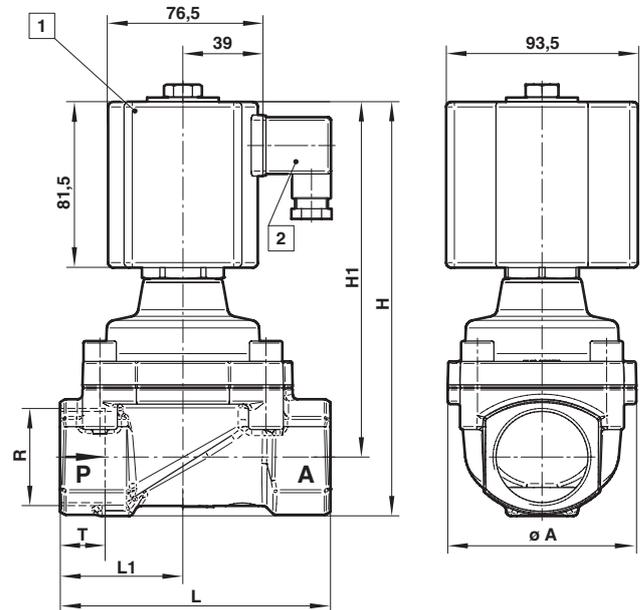
1 Elektromagnet um 360° drehbar
