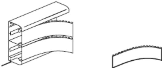
Couvercle souple à double accrochage, performant, facile à installer et qui épouse les angles pour une finition esthétique irréprochable.
