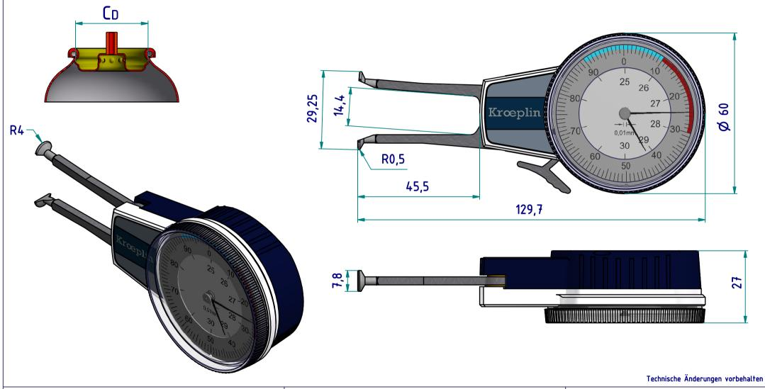
Serie: Aerosol Messbereich: 25 - 29 mm Anzeigebereich: 23,75 - 29,25 mm
