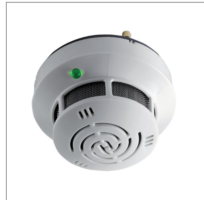
Der optische Rauchschalter ORS 142 erkennt frühzeitig sowohl Schmelzbrände als auch offene Brände mit Rauchentwicklung. Ein zusätzlicher Temperaturfühler spricht bei einer Umgebungstemperatur von 70 °C an. In Bereichen mit Störgrößen wie Dampf, Staub, Betauung und betriebsbedingter Rauchentwicklung empfehlen wir den Einsatz unseres Thermodifferentialschalters TDS 247. Es sind die länderspezifischen Vorschriften zu beachten.
