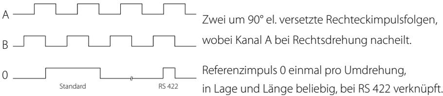
Alle Kanäle können auch invertiert ausgeführt werden.
