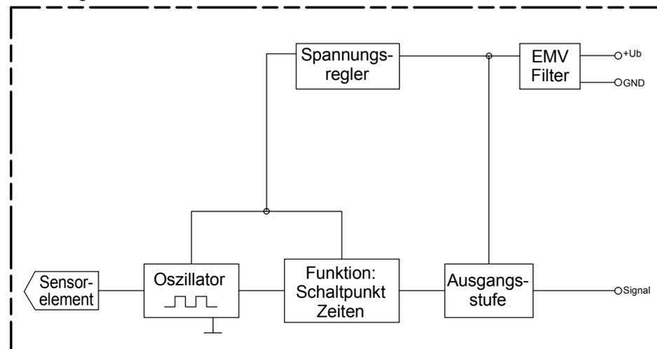
**Funktionsdiagramm für MINIMUM Sonden**
