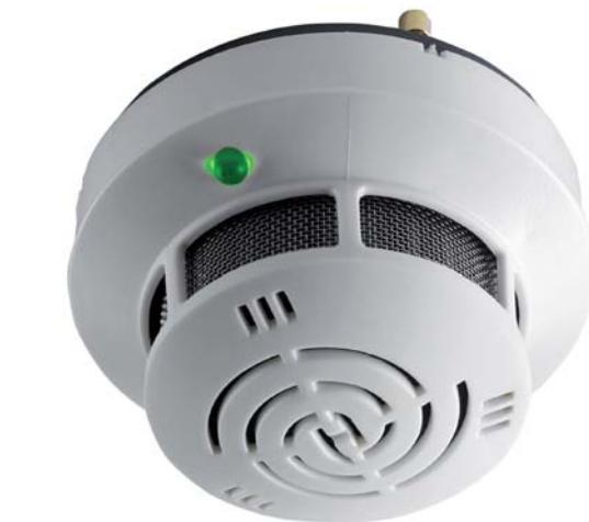
Der optische Rauchschalter ORS 142 erkennt frühzeitig sowohl Schmelzbrände als auch offene Brände mit Rauchentwicklung. Ein zusätzlicher Temperaturfühler spricht bei einer Umgebungstemperatur von 70 °C an. In Bereichen mit Störgrößen wie Dampf, Staub, Betauung und betriebsbedingter Rauchentwicklung empfehlen wir den Einsatz unseres Thermodifferentialschalters TDS 247. Es sind die länderspezifischen Vorschriften zu beachten.
