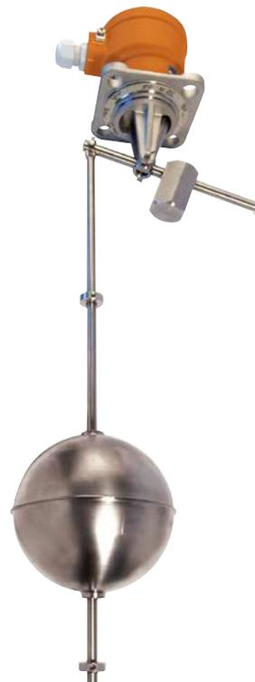
Die Hysterese kann durch Positionieren der Ringe auf der Stange eingestellt werden. Durch die Positionierung des Gegengewichts können die verschiedenen Stablängen ausgeglichen werden.
