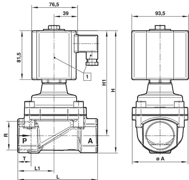
1 Elektromagnet um 360° drehbar
