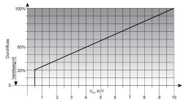
Durch die genaue Zeit- und Wegerfassung sowie der angenommenen Ventilkennlinie ist der Antrieb in der Lage, kurze t<sub>ein</sub>- und t<sub>aus</sub>-Zeiten einzustellen. Das eröffnet dem OEM Antrieb 5: Puls-Proportional ein breites Anwendungsspektrum bei Kühl- und Heizsystemen. Bei 10 V Steuerspannung ist das Ventil immer geöffnet.
