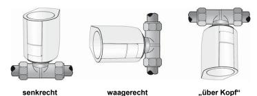
Der OEM-Antrieb ist bevorzugt in senkrechter oder waagerechter Montagelage einzubauen. Bei "über Kopf"-Montage können spezielle Umstände (z. B. Schmutzwasser) die Lebensdauer reduzieren.
