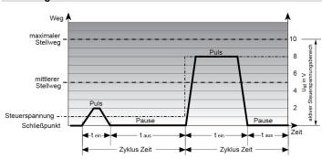
Der OEM Antrieb 5: Puls-Proportional berücksichtigt die Ventilcharakteristik, um eine höhere Bandbreite der Regelspannung auszunutzen. Gleichzeitig wird das ohnehin bei den OEM Antrieben hervorragende Parallelverhalten noch weiter optimiert. Das Parallelverhalten bezeichnet die identische Heiz-/Kühlleistung zweier Heizkreise mit jeweils einem Antrieb bei gleichzeitiger Ansteuerung.
