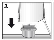
Den OEM Antrieb per Hand senkrecht auf den Ventiladapter positionieren.
