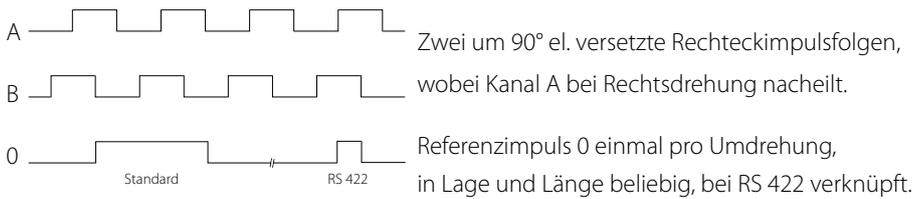
Alle Kanäle können auch invertiert ausgeführt werden.
