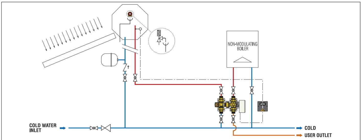
SOLAR STORAGE-TO-BOILER CONNECTION KIT
