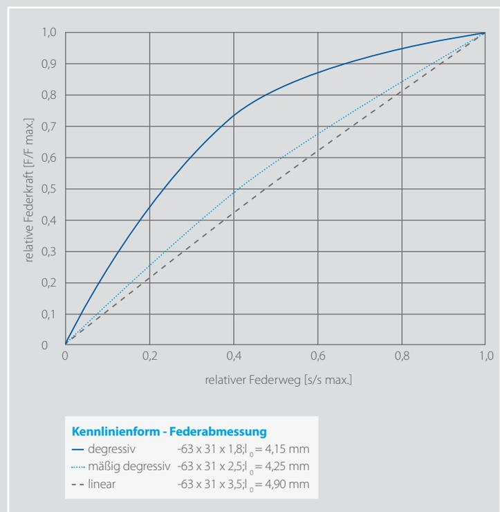
Ein wesentlicher Pluspunkt der Tellerfeder ist es, dass sie eine hohe Federkraft auf kleinem Federweg aufbringen kann. Deshalb wird sie sehr häufig zur Speicherung von potentieller Energie genutzt. Neben diesem quasi statischen Einsatz wird sie aber auch häufig in dynamischen Anwendungen eingesetzt.
