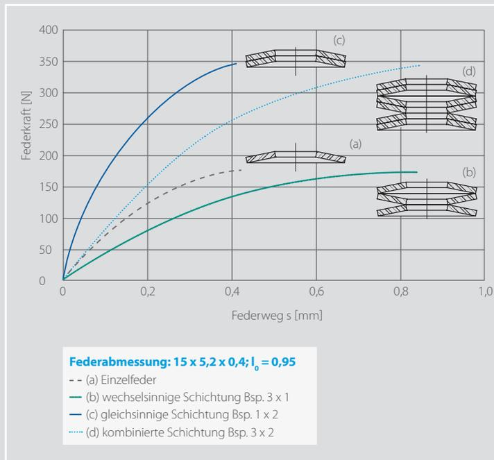
Werden Tellerfedern unterschiedlicher Dicke in geeigneter Weise angeordnet, können sogar progressive Kennlinien realisiert werden. Hierzu werden entweder mehrere Tellerfedern unterschiedlicher Materialstärke oder gleiche Tellerfedern mit verschiedenen starken Zwischenringen oder unterschiedlichen Schichtungsarten verwendet.
