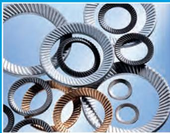
Die SCHNORR® Sicherungsscheibe hat die Form einer beidseitig gezahnten Tellerfeder mit trapezförmigem Querschnitt, deren Durchmesser auf die Schraubenmaße abgestimmt ist. Der Außendurchmesser gleicht dem Kopfdurchmesser von Zylinder- und Innensechskantschrauben.
