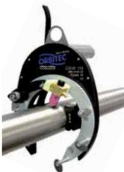
Offene Schweißzangen werden auf einer Seite des Schweißstoßes gespannt. Während der Schweißung rotiert der gas- oder wassergekühlte Brenner mit Schlauchpaket um das Rohr.
