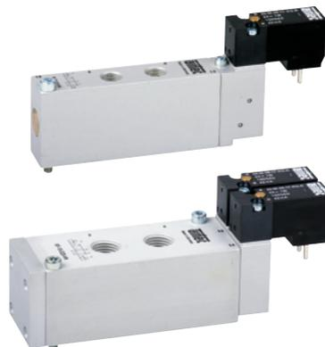
Elektrisch betätigtes Kolbenschieber-Ventil. Nach Zuschalten der Spannung wird das Ventil umgesteuert. Die Ventile sind wahlweise mit einer rastenden oder mit einer tastenden Handhilfsbetätigung ausgestattet. Die Betätigung erfolgt mittels Schraubendreher.
