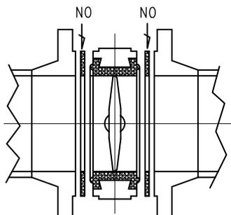
Non usare flange del tipo a saldare in testa per evitare che ad alta pressione la guarnizione subisca eccessive deformazioni.
