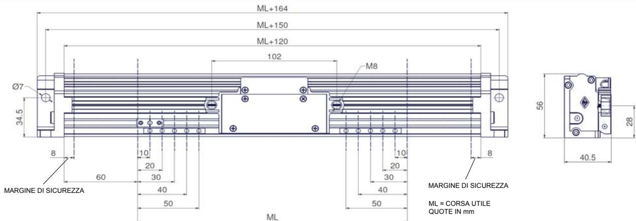
Adattatore GV-PB per intercambiabilità con riga mod. PBS-HR fornito di serie.
