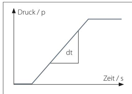
Für die mechanischen Druckschalter von SUCO gilt eine maximale Druckänderungsrate von 1.000 bar/s, für elektronische Produkte von SUCO bis zu 5.000 bar/s.
