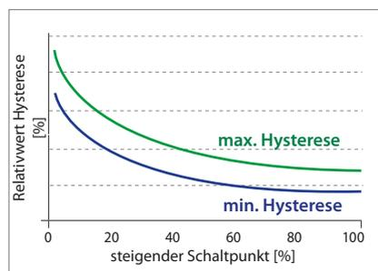
Baubedingt haben Druckschalter mit einer Überdruckfestigkeit von 100 bar kleinere Hysterese gegenüber den Baureihen mit 300 bar bzw. 400 bar Überdruckfestigkeit. Kolbendruckschalter haben eine etwas größere Hysterese als Membrandruckschalter.
