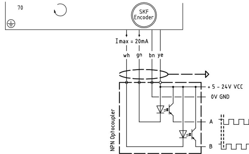
Fig.: SKF 32/48 incremental encoder
