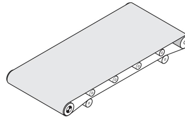
**Fig.: Roller bed conveyor**
