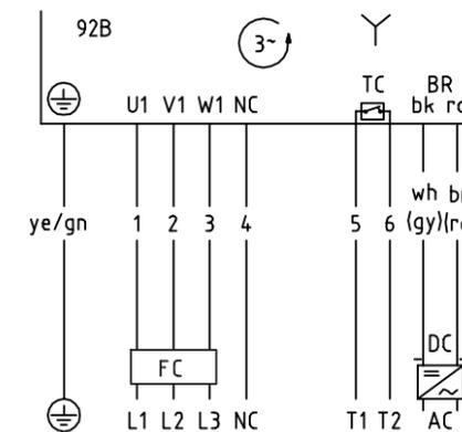
**Fig.: Motor + TC + Brake**
