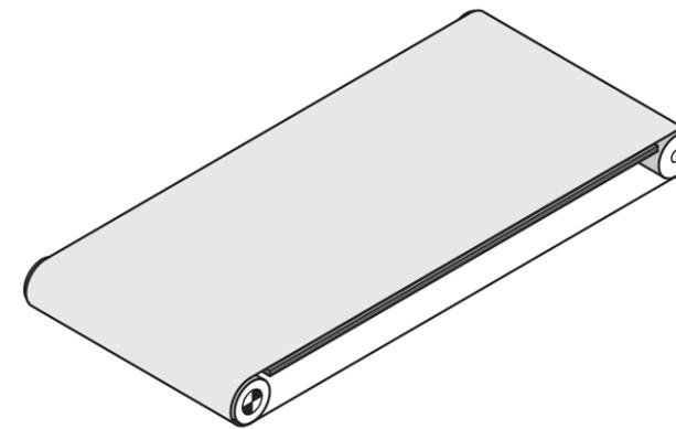
**Fig.: Slide bed conveyor**
