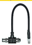
Câble, adaptateur en Y avec connecteur en T, IP67, connecteur mâle M12(X2, unité de contrôle), à 8 broches, codé A sur connecteur femelle M12 (X1,capteur), à 8 broches, codé A et connecteur femelle M8 (X3, sortied'information/Lock\_Unlock), noir, droit, à 4 broches, codé A, PUR, 0,25 m, 4× 0,25 mm², noir, pour le découplage de signaux auxiliaires lors du raccordement dePSENcode et de PSENslock.
