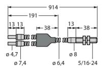
fibra óptica de vidrio, modo de detección: modo difuso, manguito roscado (latón), diámetro del haz: 3,2 mm, revestimiento flexible de acero inoxidable, temperaturas ambiente de -140...+250 °C
