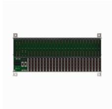
Der Modulträger MT24-N besteht aus einer Backplane und dem eigentlichen Trägersystem. Er dient zur Aufnahme von zwei Gateways, zwei Netzteilen sowie 24 E/A-Modulen. Es können so bis zu 192 binäre Ein-/Ausgänge oder 96 analoge Ein-/Ausgänge bzw. jede Mischform an den Modulträger angeschlossen werden.
