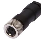
Kabeldose, gerade, Selbstkonfektionierbar, Lötanschluss, Ø3,5-5mm, 4A, 30V, -40-85°C, M8 Dose 4polig, IP67, Messing
