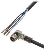
Anschlussleitung, 2m, M8 Dose 4polig abgewinkelt, freies Leitungsende, 4x0,34mm<sup>2</sup>, PUR (Polyurethan), Ø4,7mm, -30-90°C, IP67, LED, Schleppketten- und torsionsfähig, Öle und Kühlschmiermittel, Schweißbereich, Silikonfrei
