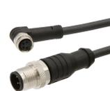
Verbindungsleitung, 0,3m, M8 Dose 4polig abgewinkelt, M12 Stecker 4polig gerade, 4x0,34mm<sup>2</sup>, PUR (Polyurethan), 60V, IP67, Schleppketten- und torsionsfähig, Öle und Kühlschmiermittel, Schweißbereich, Silikonfrei
