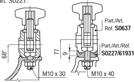
\* = Per aumentare l'altezza del supporto (di 9 mm) applicare 1 o più distanziali Part. S0227 codice 61931. L'utilizzo del distanziale richiede la sostituzione della vite standard con una di lunghezza maggiore.
