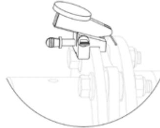
Abbildung 7 – Prüfen Sie die Winkelausrichtung mit der Rexnord-Messuhr-Methode.
