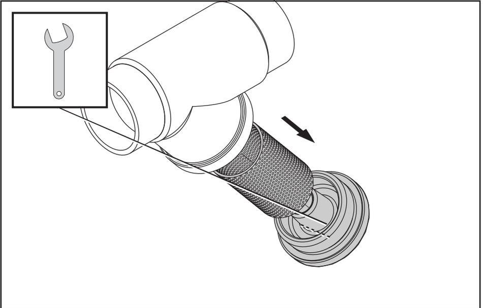
Abb. 5.2 - Schmutzfänger, Deckel demontieren (Abbildung zeigt Art. EA300064)
