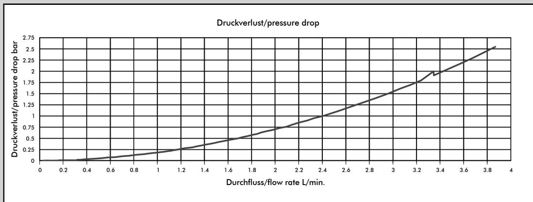
Getestet mit Wasser, max. Druck: 3.3 bar / Tested with water, max. pressure 3.3 bar
