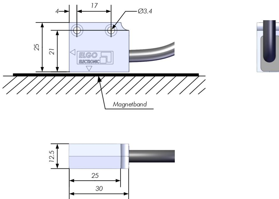
Abbildung 3: Abmessungen Sensor
