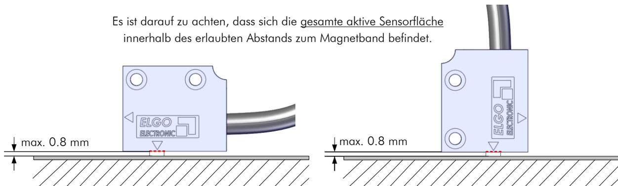
Abbildung 7: Ausrichtung des Sensors
