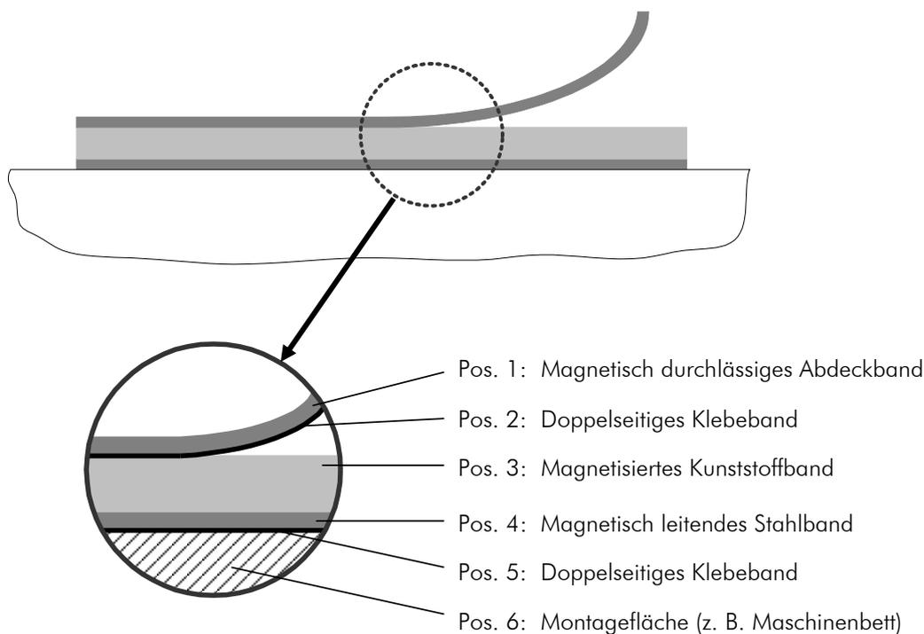
Abbildung 4 Magnetbandaufbau
