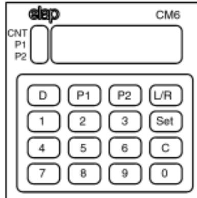
Una volta impostato il codice di configurazione desiderato premere nuovamente il tasto -**SET**- per tornare alla visualizzazione principale.
