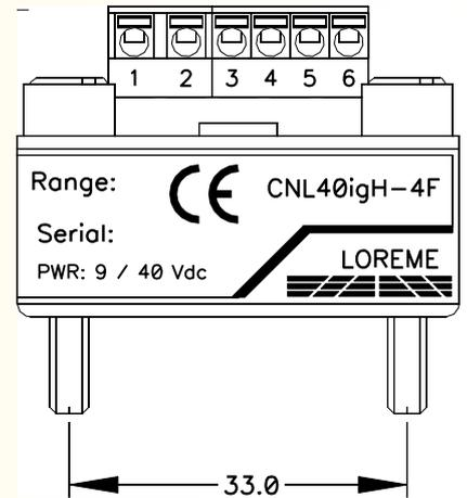
**CNL40ig:** entrée Pt100 3fils, Thermocouple ,mV, mA isolé
