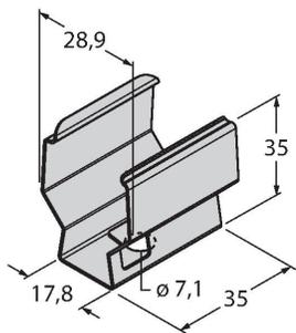
Soporte a presión para montar las luces de trabajo WLS28
