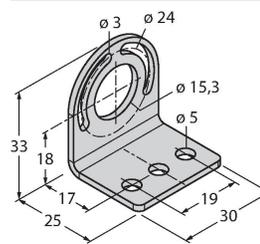
Soporte de montaje acodado de metal para luces de trabajo WLS28, orificios perforados de 5 mm, juego de tornillos incluido
