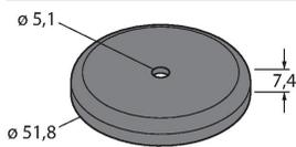
Soporte de montaje magnético para el montaje en superficies metálicas de las luces de trabajo WLS28
