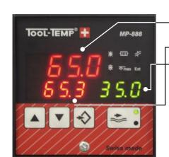
Solltemperatur / gewünschte Temperatur Verstellung der Solltemperatur in <sup>1</sup>/<sub>10</sub>°-Auflösung
