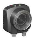
Der Bildsensor der Bauform iVu wird zur Überwachung von Typ, Größe, Ausrichtung, Form und Position von Teilen verwendet. Die Einheit besteht aus Beleuchtung, Sensor, Linse und Display. Für jede Anwendung können passende Kabel und Montagewinkel bestellt werden. Darüber hinaus sind weitere Linsen, Montagebügel, Filter und externe Beleuchtungseinheiten erhältlich. Montage, Setup und Konfiguration lassen sich schnell durchführen, ohne dass ein PC zur Konfiguration des Sensors nötig ist.
