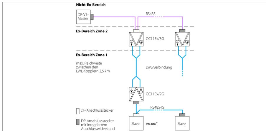
Der LWL-Koppler OC11Ex/2G.2 wandelt die PROFIBUS-DP-Signale von Kupferleitungen auf Lichtwellenleiter um. So lassen sich die Bussignale aus dem sicheren Bereich in den Ex-Bereich potenzialfrei und störungssicher über große Entfernungen übertragen. Bei der Verwendung eines Lichtwellenleiters OM1 (62,5/125µm) beträgt die maximale Übertragungsreichweite 2500m und bei OM2 (50/125µm) beträgt diese 1500m.
