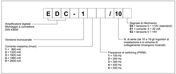
Il connettore EDC-1 è un amplificatore digitale per il comando in anello aperto di valvole proporzionali.
