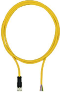
Câble de raccordement, PUR, jaune RAL1003, compatible avec chemin decâbles mobiles, connecteur femelle droit M12 à 8 broches, libre de câblage, codé A, longueur du câble : 5m
