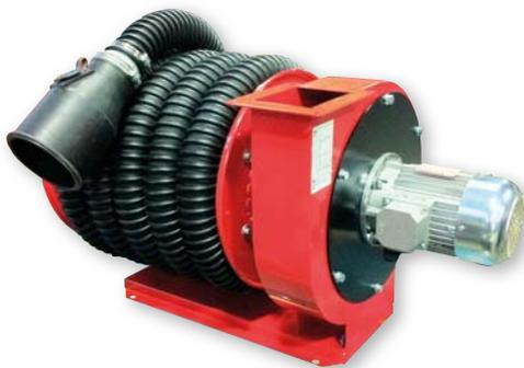
Avvolgitubo automatico a molla in acciaio verniciato con elettroaspiratore centrifugo, adatto per aspirazione gas di scarico completo di flessibile antischiacciamento di diversi diametri e lunghezze, fermatubo e bocchetta di aspirazione con tappo a diaframma.
