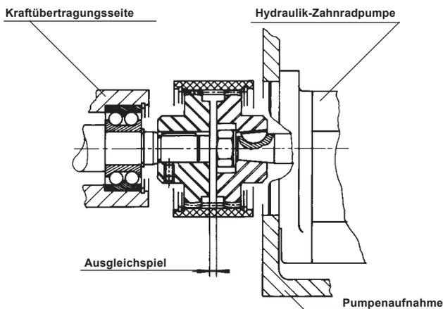
Einbau mit 3 - teiliger Kupplung mit ausgewölbten Zähnen
