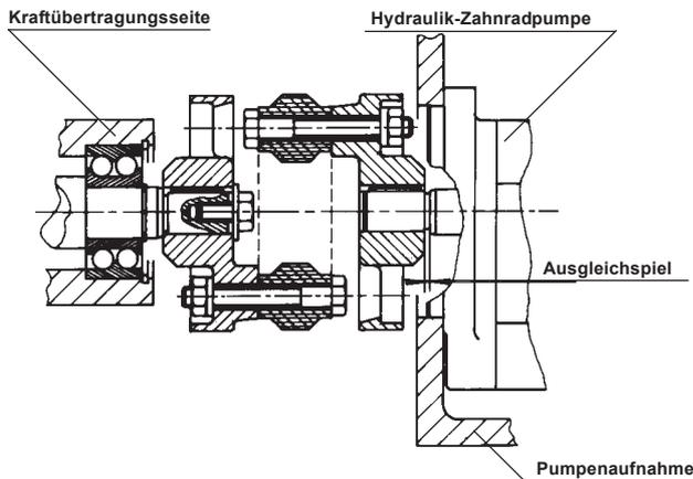
Einbau mit 3 - teiliger elastischer Kupplung
